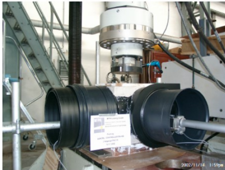
8. ábra: Az AS ellenőrző aknán végzett kísérlet felépítése
